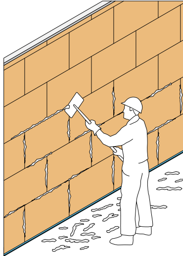
Figura 74. Cepillado de la fábrica.
