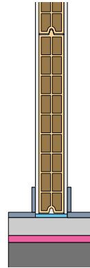
Aplicación del yeso en un tabique interior con arranque sobre el suelo flotante. Aplicación del yeso hasta la banda elástica.
