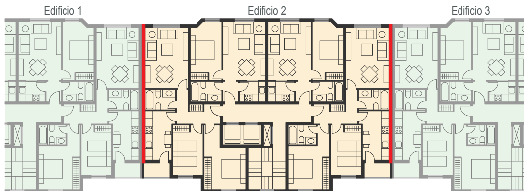
Figura 14. Medianerías de un edificio de viviendas.
